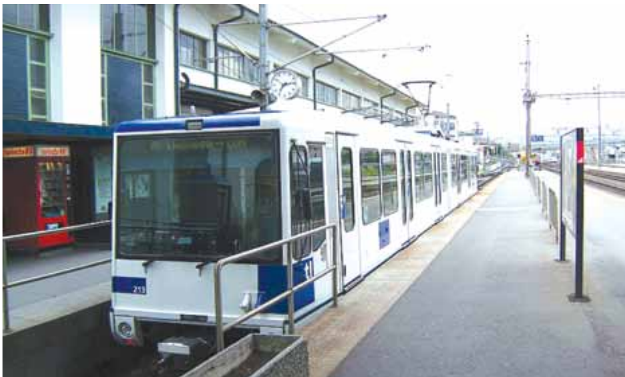
Перони на станица на системот лесно метро кои се во ниво со подот на возилата (систем лесно метро во Лозана, Швајцарија)
