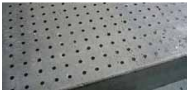
Транспарентен бетон со пластика наместо оптички влакна
