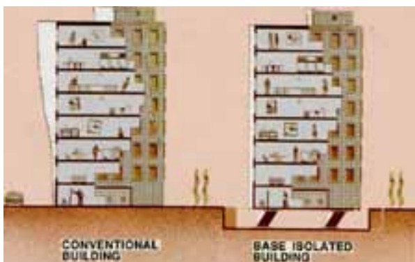
Сл. 4 Компарација на движењето кај "класична" и "базно изолирана" конструкција
