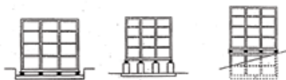
Сл. 3 а,б,в - Различни местоположби на изолацискиот систем во конструкцијата
