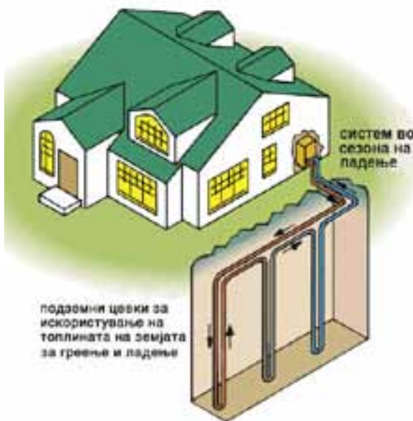
Сл. 2.10. Цевен систем за складирање, или вадење на топлината од земјата во сезоната на ладење или греење
