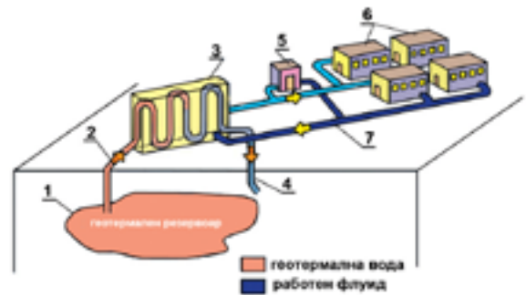
Сл. 2.3. Затворен систем за централно греење со геотермална вода (со изменувач на топлина) 1-геотермален резервоар; 2-извор на топла вода; 3-изменувач на топлина; 4-понор на топла вода; 5-постројка за врвни оптоварувања; 6-станбени згради; 7-цевковод за работен флуид.
