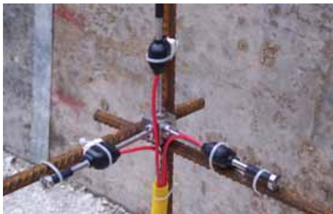
Сл. 2 Детал на монтирана оскултационна опрема
