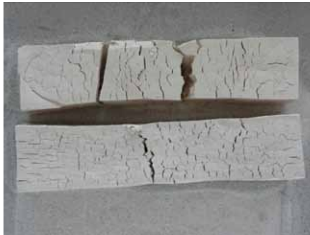
Слика 1. Разлика во оштетувањето помеѓу стандардна и Кнауф-противпожарна плоча под дејство на пожар.
