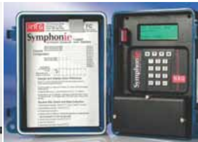
Слика 6. Логер на податоци од компанијата NRG Systems, искористен во мерните станици
