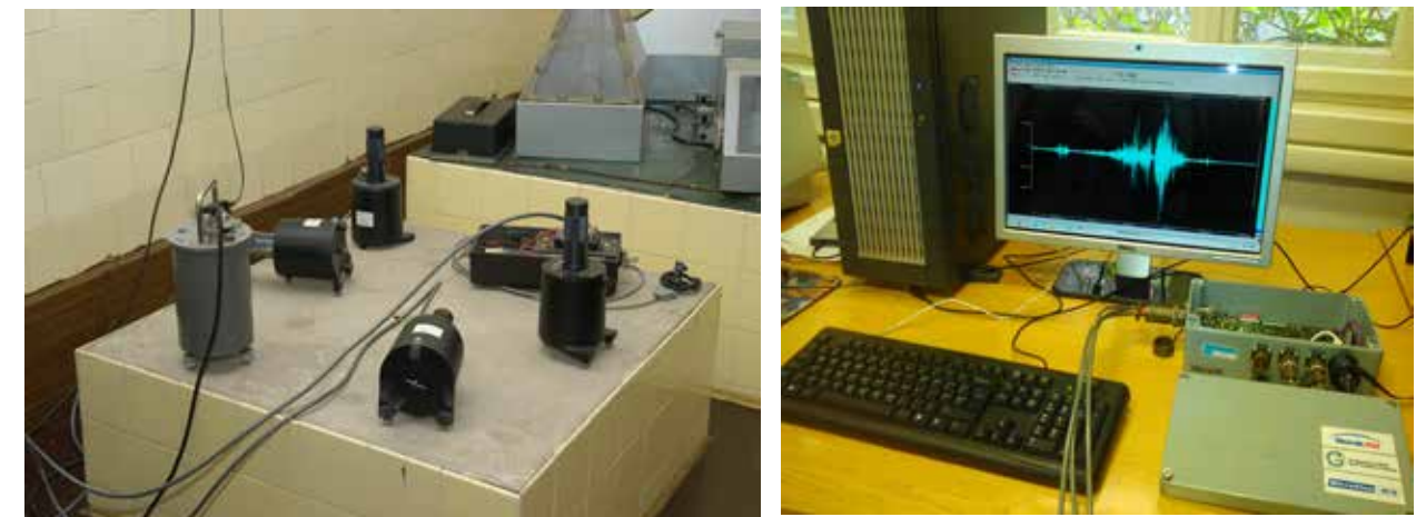
Слика 4. Модерни инструменти во Сеизмолошката опсерваторија при ПМФ во Скопје: (лево) кратко-периодични и широко-појасни електромагнетни сеизмометри; (десно) еден од типовите дигитајзери што се користат со овие сеизмометри, заедно со добиената дигитална регистрација на компјутерски монитор
