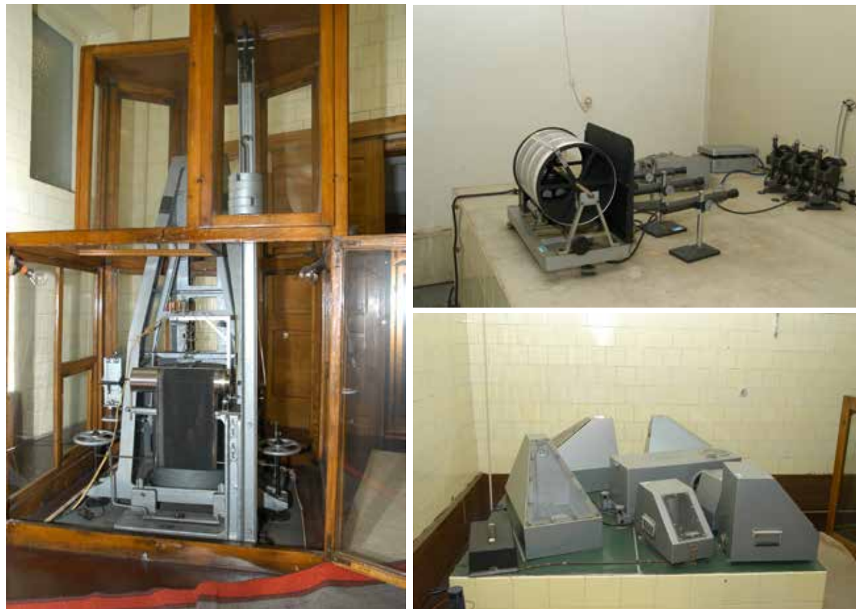
Слика 3. Инструменти во Сеизмолошката опсерваторија при ПМФ во Скопје: (лево) механичкиот сеизмограф MAINKA, монтиран во 1957 г. (регистрација со игла на начадена хартија поставена на цилиндар што ротира; (десно) појасно-ограничени електромагнетни сеизмометри (горе), кои во својата редовна работа, од средината на 1960-тите години до раните 1990-ти години, се користени со галванометриска регистрација на фотографска хартија поставена на цилиндар што ротира (долу)
