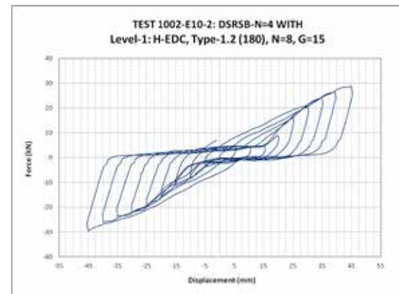
Слика 6.3. Експериментално дефинирана оригинална хистерезисна зависност сила-поместување на два развиени карактеристични иновативни типа на уреди за дисипација на енергија (EDD) од хоризонтален Н-тип
