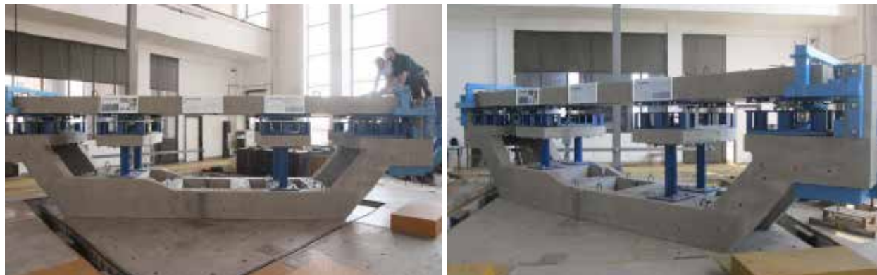
Слика 7.1. Конструирани иновативни модели на мост во голем размер на вибро-платформа со вклучени шест варијанти на моделот на новите ML-MD GOSEB-системи за сеизмичка заштита: BM1, BM2, BM3, BM4, BM5 & BM6
