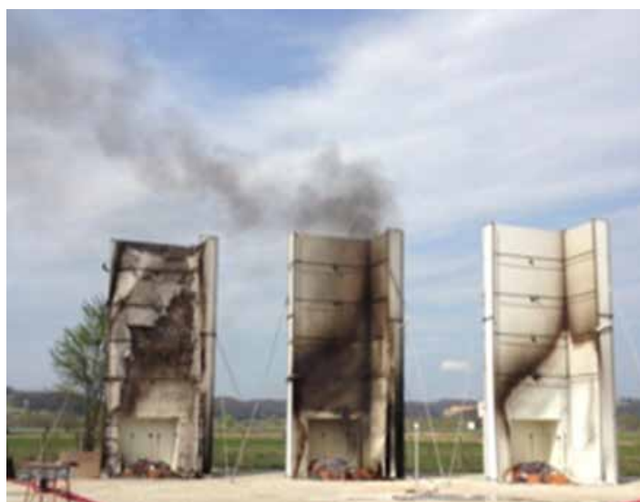
Слика бр.3. Изглед на тестните системи на крајот на испитувањето (лево), поради претпазливи мерки пожарникарите ги полеваат примероците со вода
