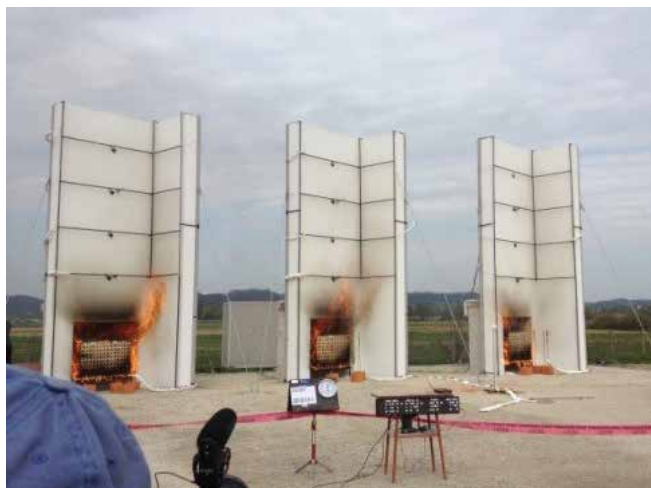
ts + 4 мин.: пожарот почнува да го зафаќа Примерокот бр. 1
