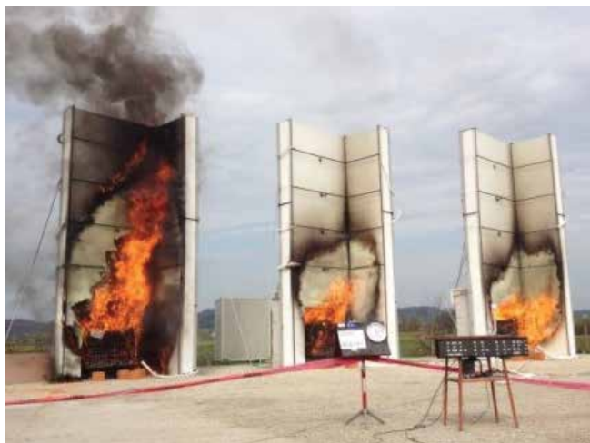
ts + 11 мин.: пожарот се проширил до врвот на
