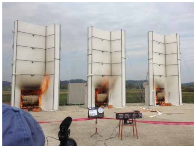
ts + 26 мин.: EPS на Примерокот бр. 1 изгорел
