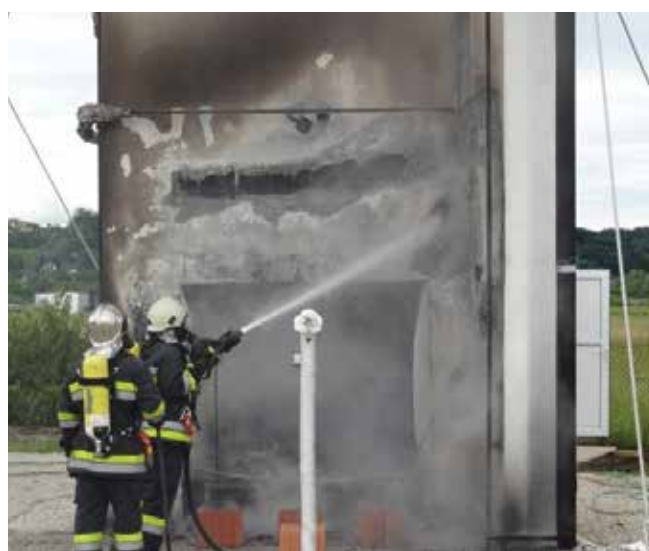
Слика бр.3. Изглед на тестните системи на крајот на испитувањето (лево), поради претпазливи мерки пожарникарите ги полеваат примероците со вода
