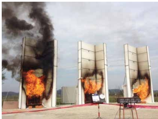
ts + 7 мин.: пожарот ги зафати сите три примероци, и дојде до проширување на чадот кај Примерокот бр. 1
