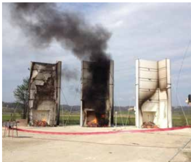
ts + 33 мин.: самогасење на пожарот на Примерот бр. 1 (изгорен е целиот фасаден систем); емисија на чад на Примерот бр. 2 од капките на ЕПС кој се запалил; самогасење на пожарот на Примерот бр. 3 (изгорено е дрвото за потпалување)
