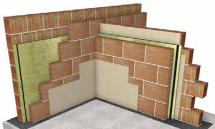
Слика 3. Преграден ѕид со исти материјали и различна звучна изолациона моќ
