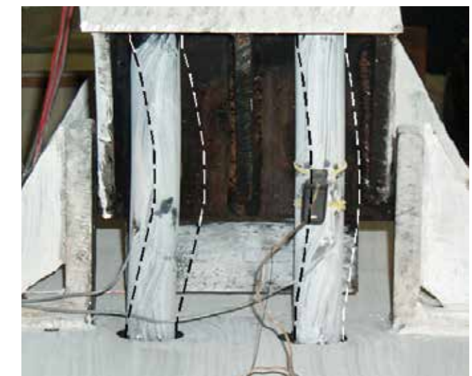
Слика 5. Интелигентна врска греда – столб со примена на Ni-Ti завртки
