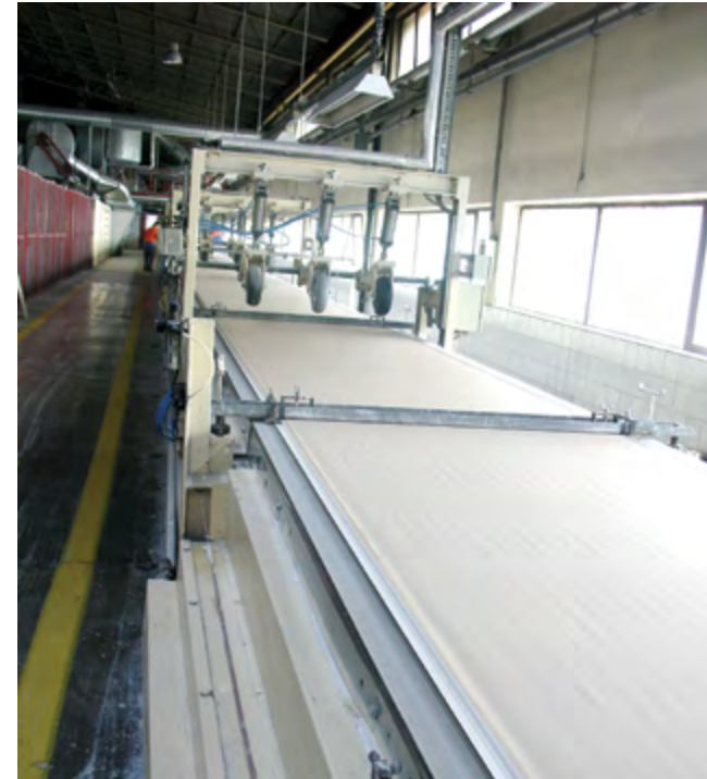
Сл 1. Производна лента на Кнауф за изработка на гипс картонски плочи
