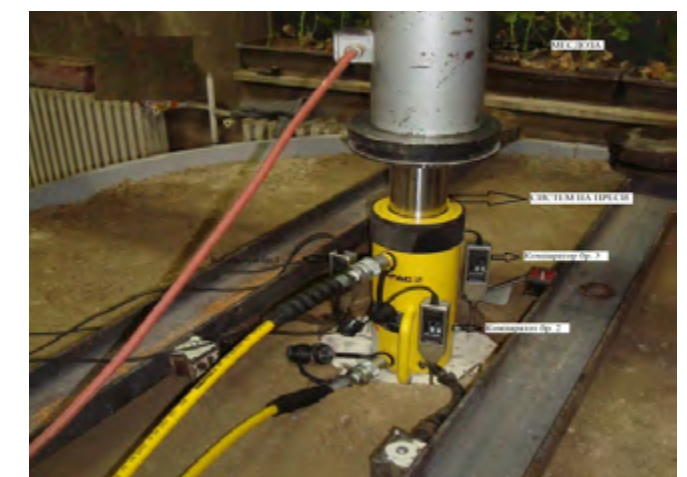
Слика 5. Мерна техника за регистрација на товарот и деформациите
