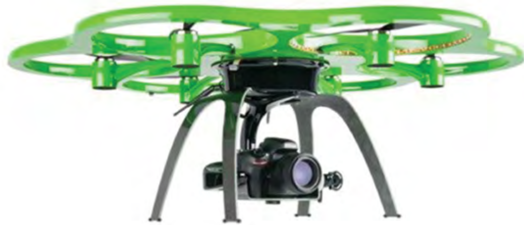
Сл. 1 – Беспилотни летала со ротирачко крило (rotary wing) и фиксно крило (fixed wing)
