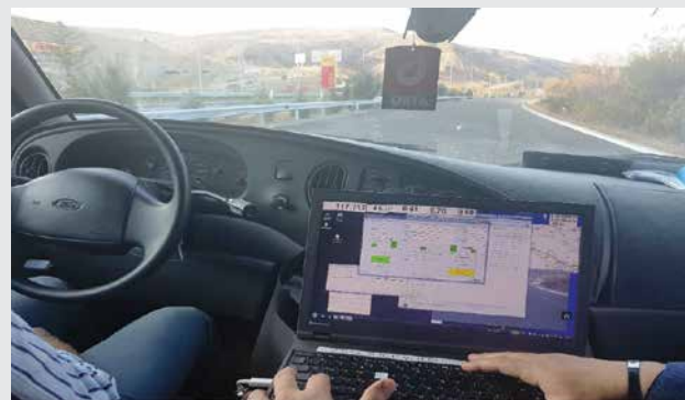
Слика 4. Мерење на рамност на коловозната конструкција со мерен апарат високо брзински инерцијален профилер
