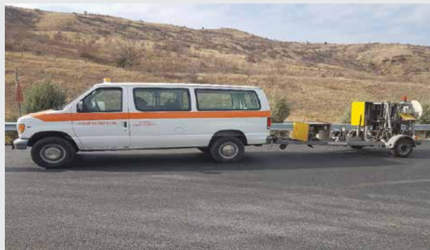
Слика 5. Мерење на носивост на коловозната конструкција со мерен апарат дефлектометар
