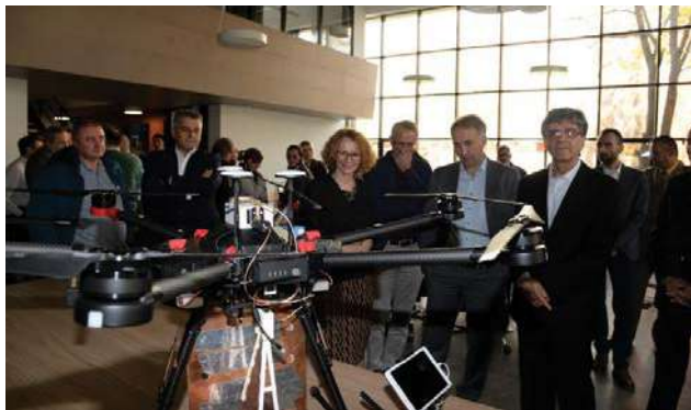
Слика 6. Георадарот интегриран со дрон на презентацијата на ФЕИТ
