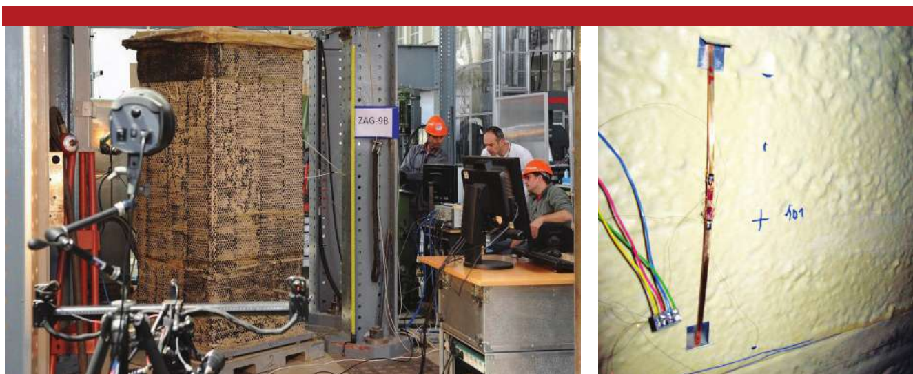
Слика 3. GRS примерок испитан со триаксијален метод (лево) и сензор за мерење на мали локални деформации (десно)
