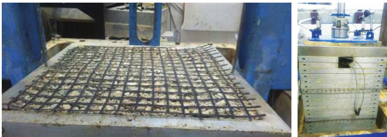
Слика 5. Подготовка на GRS примерок за испитување (лево) и уред за опит на едноставно смолкнување (десно)
