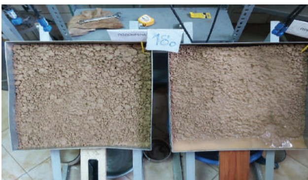
Слика 6. Експериментално испитување на третирана косина (лево) и природна косина (десно) Фотографии од а) 0 минути б) 60 минути в) 120 минути г) 180 минути – крај на испитување
