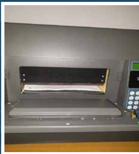
Слика 3: Примероци од обичен филц, примерок поставен во инструментот за испитување
