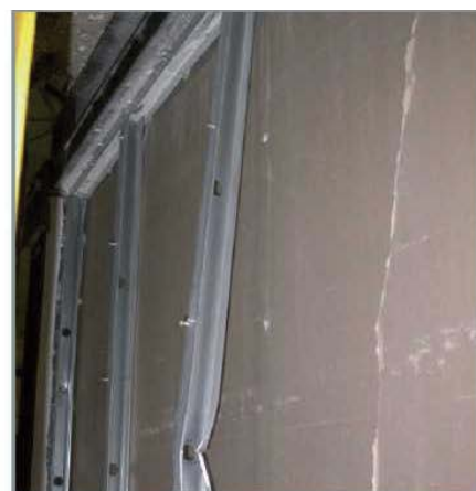
Различни нивоа на оштетувања на Кнауф системи при хоризонтално или вертикално поместување до 27 mm
