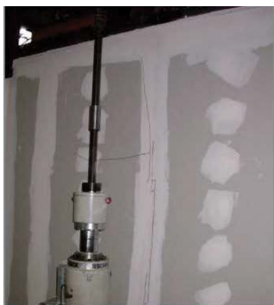
Различни нивоа на оштетувања на Кнауф системи при хоризонтално или вертикално поместување до 27 mm
